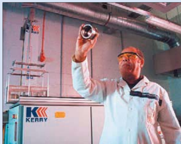
Les unités cosolvantes Microsolve retirent toutes les traces d'huile, de graisse et de carbone
